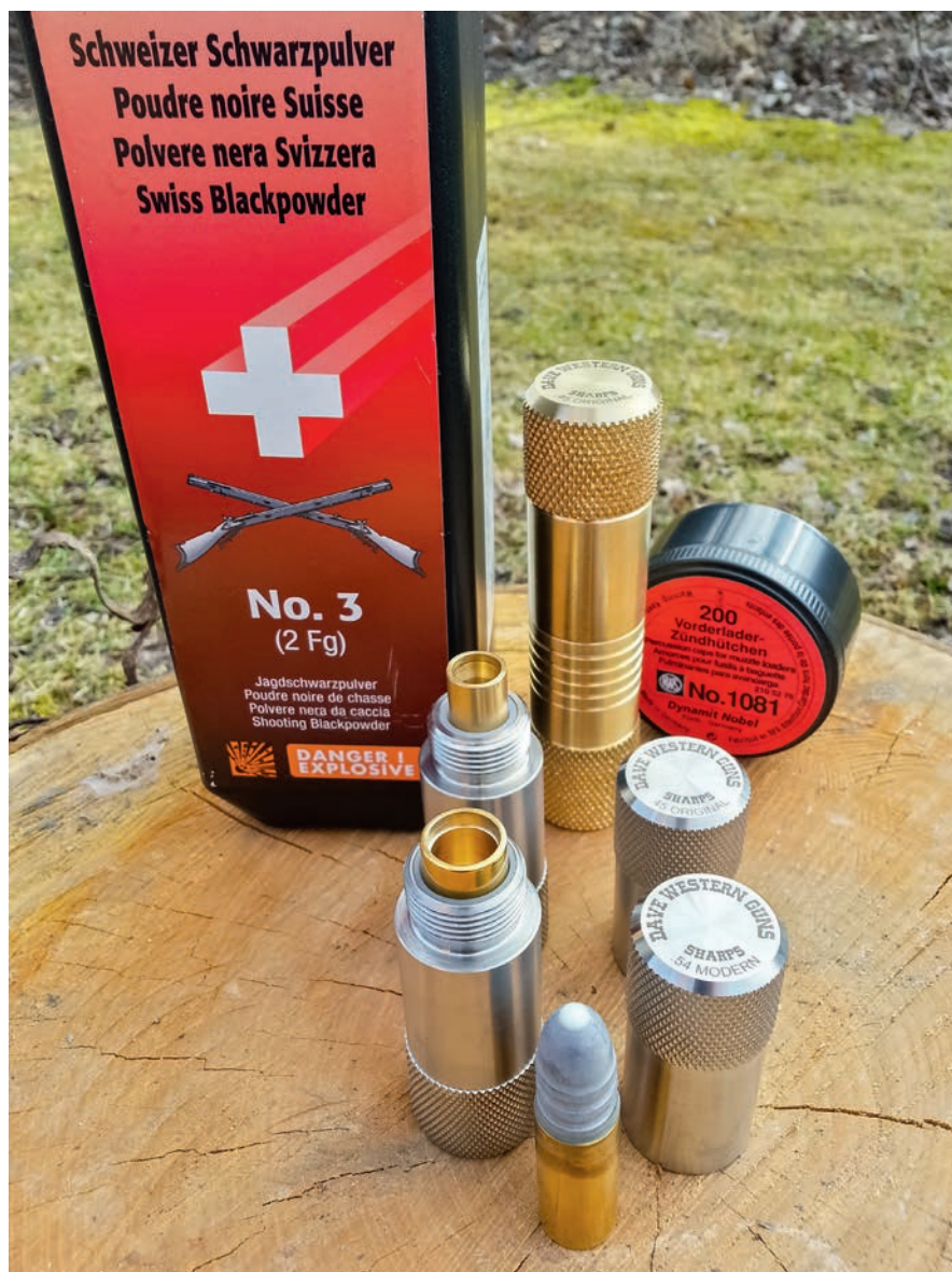
■ Šroubové přebíjecí lisy pro přebíjení kovových nábojnic .54 Sharps a .45 Sharps
