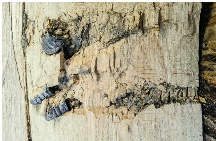
■ Střely modern ráže .54, zachycené v tvrdém dřevě (střelba ze vzdálenosti 100 m)
