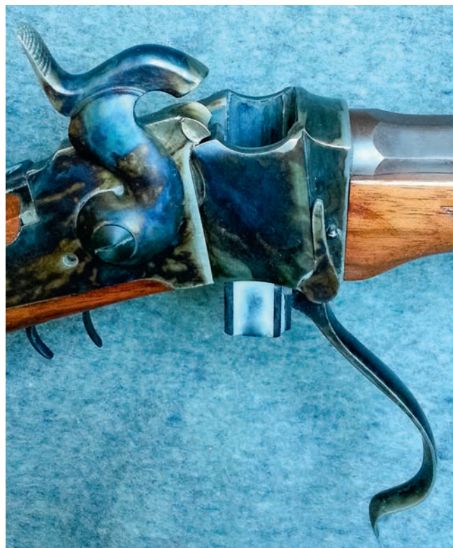
■ Závěr Sharps se svisle posuvným blokem
