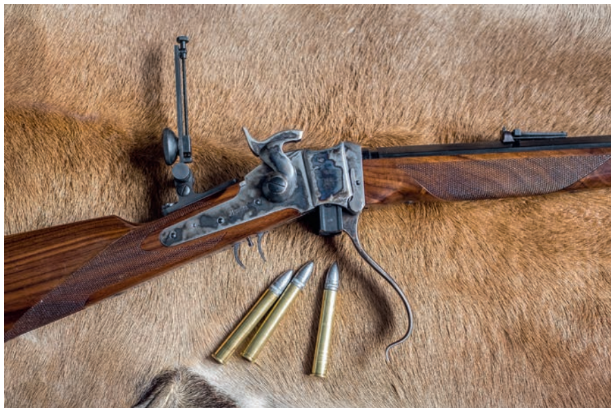
Blokový závěr Sharps M1874. Kohout v první poloze, závěr otevřen stažením lučičku, zbraň je připravena k nabíjení.
