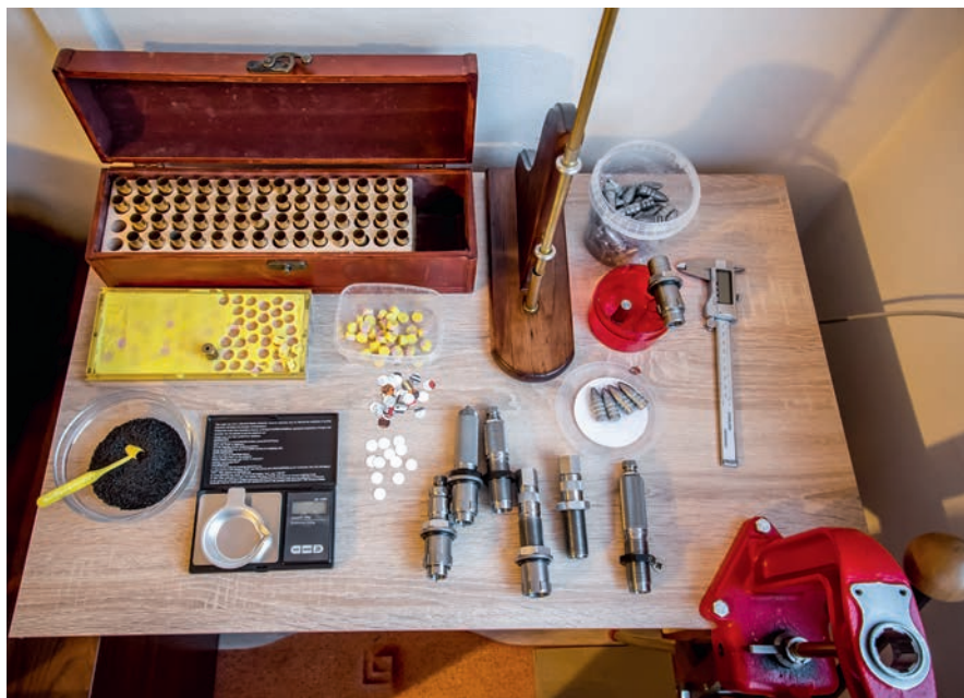
■ Nástroje k přebíjení náboje 45-110 černým prachem. Prach se před lisováním do nábojnice sype dlouhou trubicí, která se na fotografii celá nevešla.
