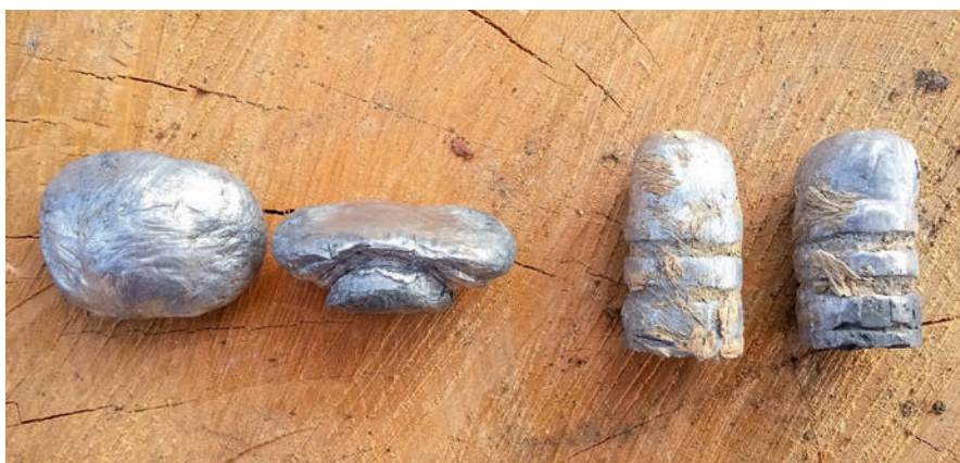
■ Vlevo střely typu modern, ráže .54 (.541), odlité z měkkého olova a vyjmuté z tvrdého dřeva, vpravo tytéž střely, odlité z tvrdší slitiny olova
