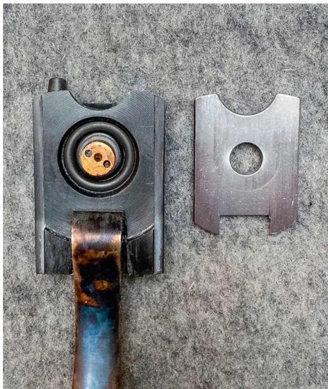
■ Závěr se závěrovou destičkou, těsněnou O-kroužkem
